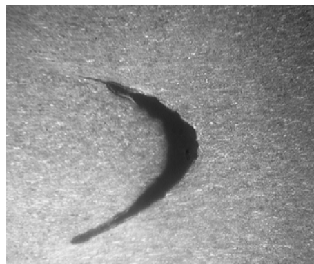
圖二十六 試片縱切面縮孔的殘餘
