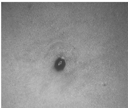
圖二十五 試片橫切面上中心有孔洞
