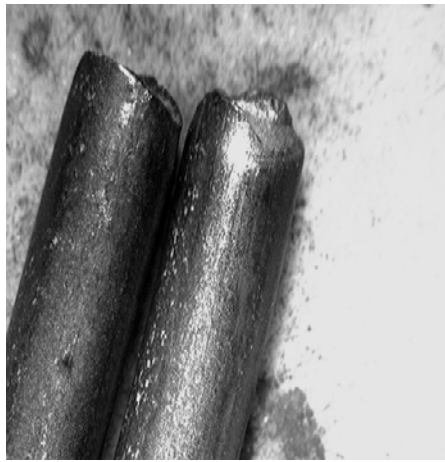
圖十八 線材夾雜物造成斷裂
