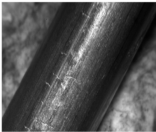
圖八 鋼線表面的橫裂
