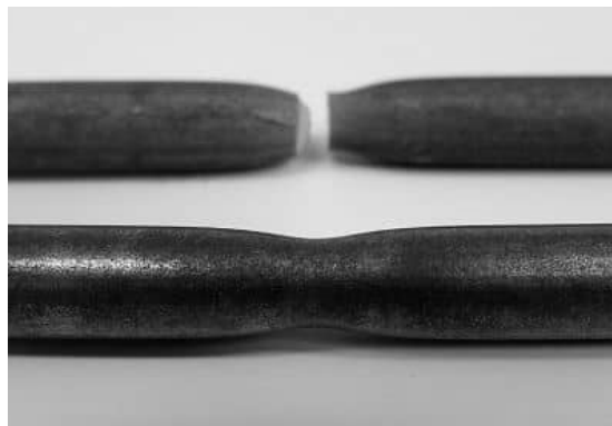
圖一 韌性斷裂斷口
